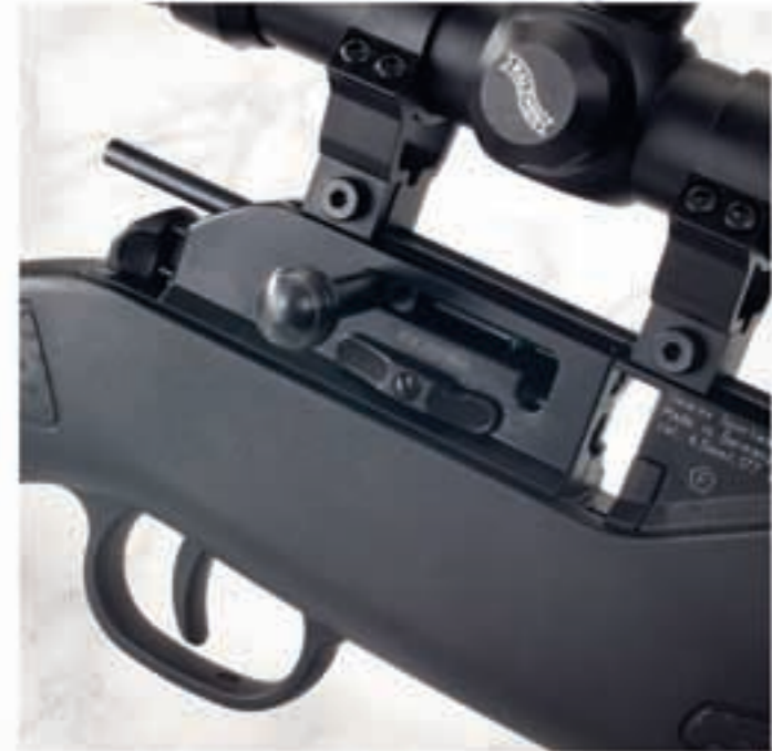
Die volle Ladung: Das Air Magnum vereint Acht-Schuß-Trommel und klassisches Repetiersystem mit Kammerstengel (oben). Die Waffe ließ sich nicht einspannen, sitzend aufgelegt gelangen Gruppen von umschlossenen 7 mm. Bei besserer Abzugscharakteristik wäre wohl noch mehr drin. Vor allem die große 88-Gramm-Kapsel begeistert. Nach mehr als 200 Schuß kam für den Tester der Abgabetermin, die CO 2 -Kartusche wies aber immer noch Druck auf.
